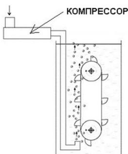
Компрессор подает воздух в бак с водой. Поднимаясь в баке, воздух наполняет ковши (поплавки). Механизм вращается за счет Архимедовой силы. Электрогенератор вращается за счет цепной или ременной передачи от вала поплавкового механизма. Расчеты Маркелова предполагают, что мощность, затрачиваемая на работу компрессора в десятки раз меньше мощности, вырабатываемой данным механизмом. Следовательно, данная система может работать в автономном режиме.
