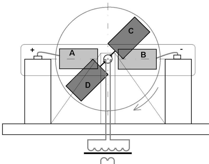
В простом варианте, можно использовать один диск и две неподвижные пластины А и В, соединенные с накопительными конденсаторами. Вращение диска с пластинами С и D можно обеспечить любым способом, например электромотором. Впрочем, машина сама по себе является мотором и диск можно заставить вращаться без внешнего привода. Пластины С и D при движении около пластин А и В поляризуются. Ток с них можно снимать через контактные щетки, подключенные к понижающему трансформатору.
