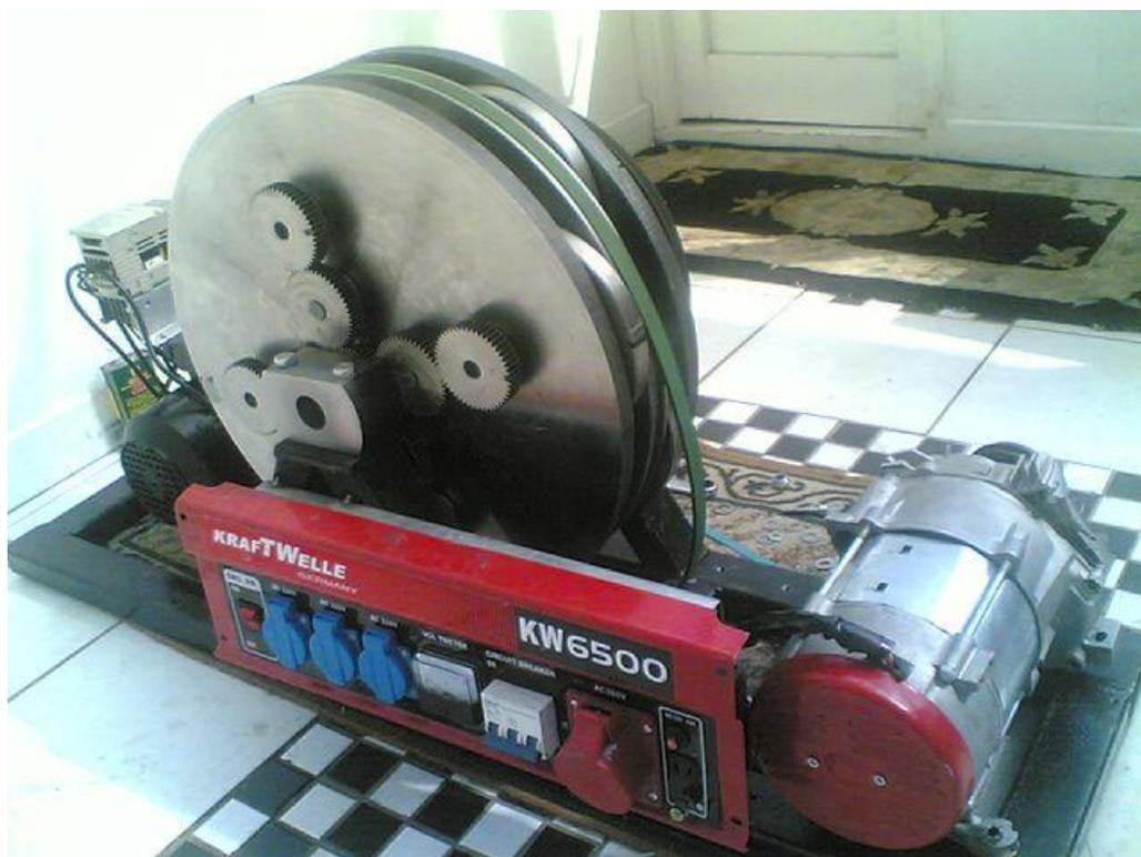
На фото виден двойной ротор, за радиус ротора выступают эксцентрики. Они вращаются за счет взаимодействия шестеренок. Генератор на фото справа, мотор видно слева.
